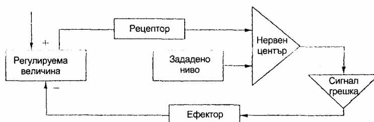
Фиг. 12. 1. Схема за регулация на принципа на обратна отрицателна връзка.
